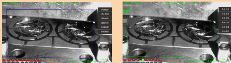
模拟相机位移之后的成像偏移-识别到框内特征没变，不报警
