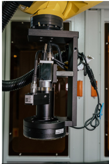
视觉组件： 工业面阵相机+液态镜头 • 堆栈式CMOS成像 • 液态自动对焦
