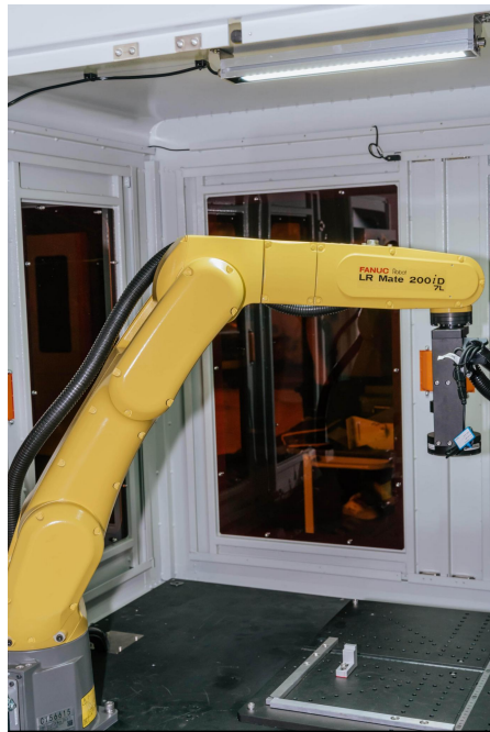
机械手： Fanuc Mate 200id迷你型机器人 • 六轴控制 • 可达半径717mm
